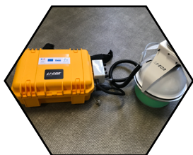
Matériel de mesure comme ce LI-COR: LI-8100-S1 Survey package (mesures des échanges gazeux).
