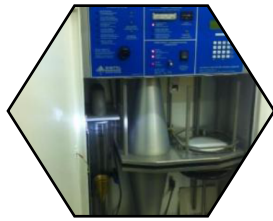
Préleveur de filtres à haut débit (Digital DA80).
