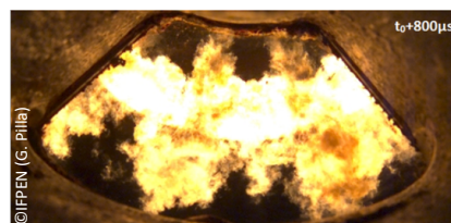
Photo : Distribution de suies (couleur jaune) au sein de la chambre de combustion d'un moteur Diesel.
