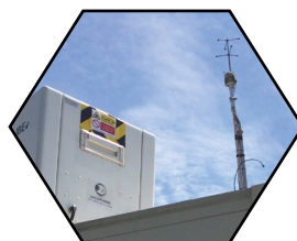
Lidar profileur de vent et anémomètre à ultrasons (campagne COBIACC).
