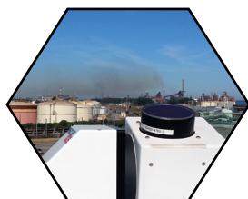
Périscopes du lidar vent à balayage (Dunkerque, Halle aux Sucres).
